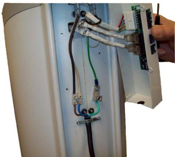
6. Die Abdeckung des Anschlusskastens wieder anbringen.
