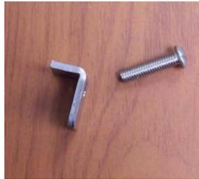
2. 1 Winkel mit einer der kleinen Öffnungen an der Halterung ausrichten. Eine Schraube durch die Öffnung an der Wandhalterung in die Öffnung am Vantage-Panoramagerät einsetzen. Die Schraube mit einem Innensechskantschlüssel (4 mm) leicht anziehen. Noch nicht fest anziehen.
