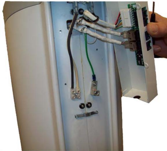
3. 1 Schraube an der Zugentlastungsklemme lösen, um die Adern einschieben zu können. Die Schraube für den späteren Zusammenbau aufbewahren.
